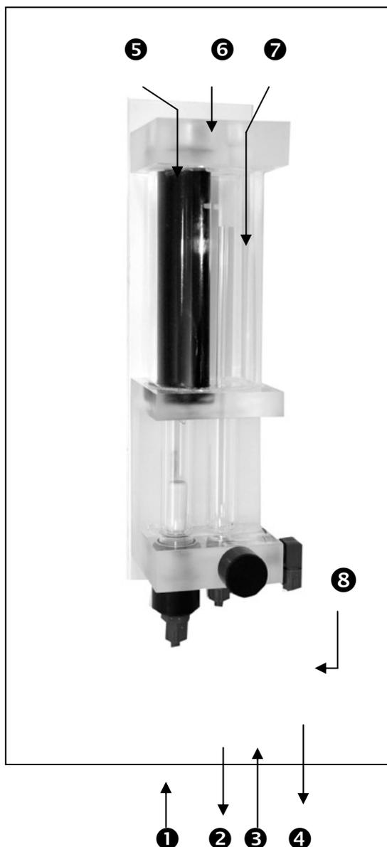
**УКАЗАНИЕ:** компактную ячейку PP204 (0131-017-05) использовать только с волоконным фильтром арт. № 0101-120-00.
